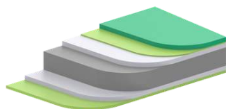
■ Polyester coating (20 µm) ■ Primer (5 µm) ■ Zink ■ Bandstaal
